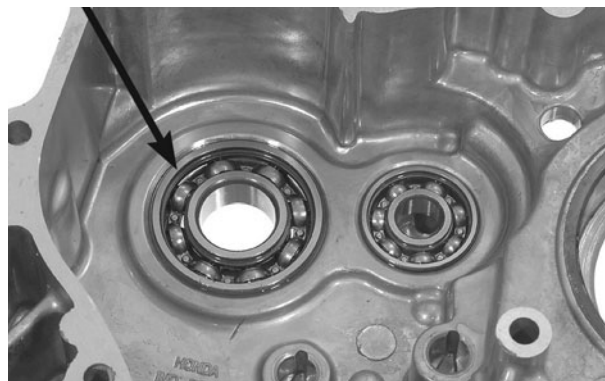
CABEÇOTE EXTRATOR, 12 mm ROLAMENTO DA ÁRVORE PRIMÁRIA
