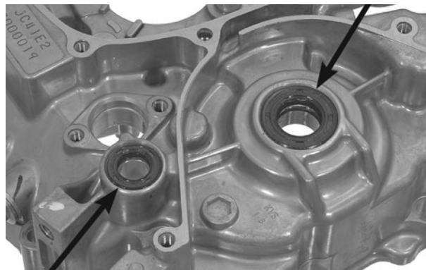
RETENTOR DE PÓ DO EIXO SELETOR DE MARCHAS ROLAMENTO DA ÁRVORE SECUNDÁRIA
