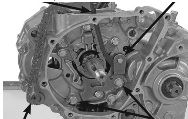
CORRENTE DE DISTRIBUIÇÃO PARAFUSO
